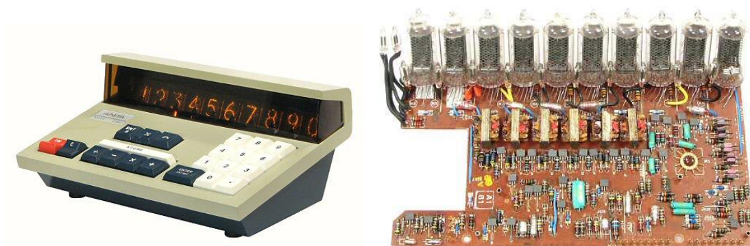
Figura 3. Apariencia de una calculadora inglesa ANITA (izquierda) y apariencia de sus circuitos (derecha). A pesar de que esta calculadora es de 1971, guarda muchas semejanzas con las calculadoras que las empresas japonesas comenzaron a imitar.
